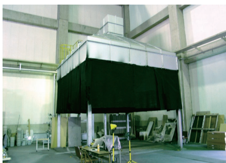
燃焼熱量測定用フード (5×5m)
