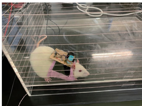
図1 埋込み型運動量計に対するワイヤレス電力伝送
