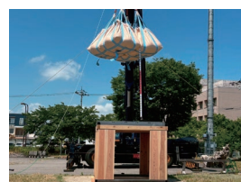
写真4 耐震シェルターの実験
