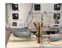
固体高分子型燃料電池と自動供給空気湿度管理システム
