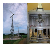
多数台小形風車の出力変動計測と固定速フライホイール電力貯蔵実験装置
