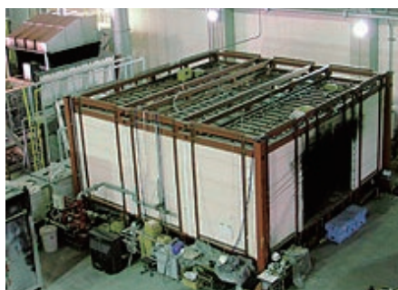
火災実験用実大区画 (散水設備対応)
