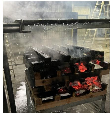
写真3 限界消火剤供給率の測定
