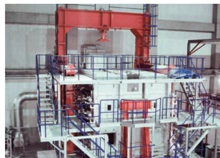
多目的水平荷重加熱試験装置
