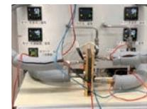
固体高分子型燃料電池と自動供給空気湿度管理システム
