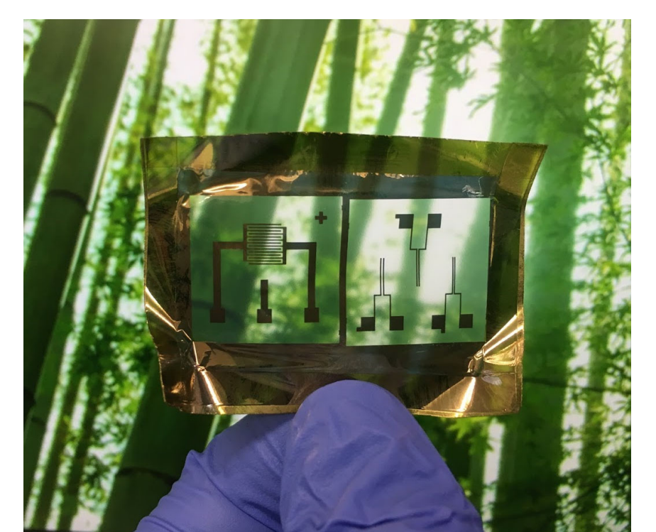
●肉薄平坦セルロースナノファイバーフィルムの作製技術を開発。太陽電池等の薄膜デバイスを搭載可能。
