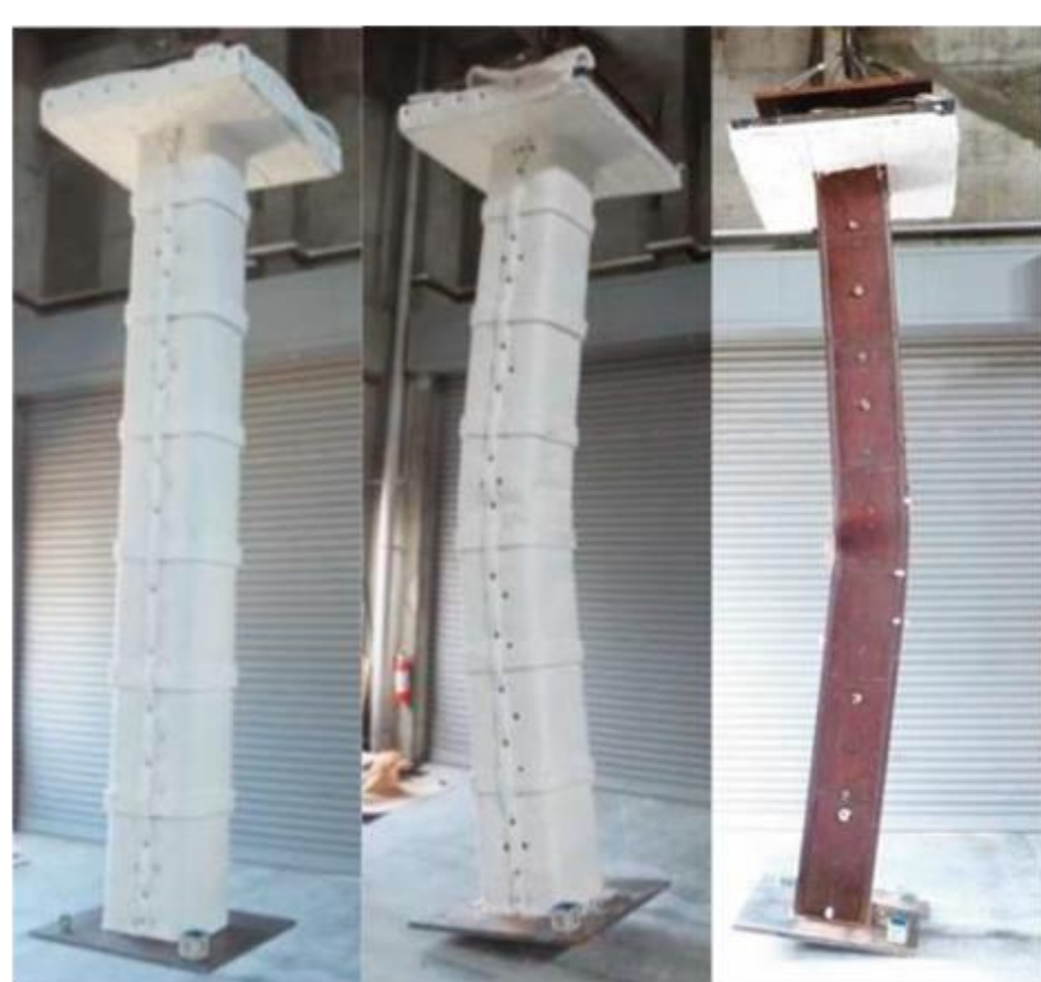
YP500鋼柱の耐火試験体 (試験前，試験後，被覆除去後)
