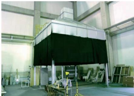
燃焼熱量測定用フード (5 × 5m)
