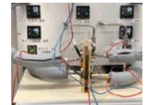
固体高分子型燃料電池と自動供給空気湿度管理システム
