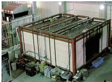
火災実験用実大区画 (散水設備対応)
