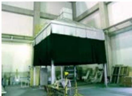
燃焼熱量測定用フード (5×5m)
