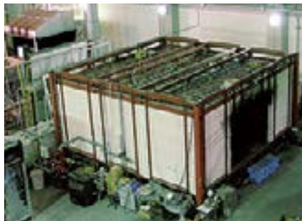
火災実験用実大区画 (散水設備対応)
