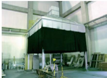
**燃焼熱量測定用フード (5 × 5m)**
