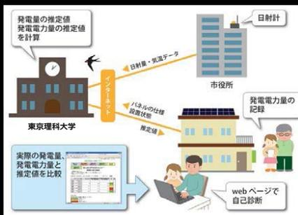
インターネットを使った太陽光発電システムの自己診断支援システムを構築
