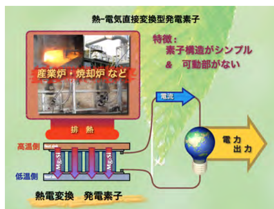
図2 排熱から電気を得る熱電変換素子
