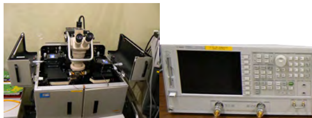
図2 アナログ集積回路チップ解析設備 (左：電圧電流検出部、右：測定解析部)
