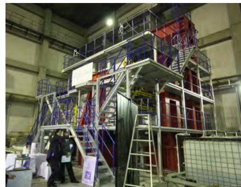
⑥多目的水平載荷加熱装置
