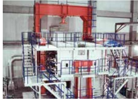
**多目的水平載荷加熱試験装置**
