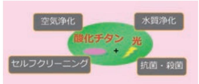
図 2 光触媒の応用分野
