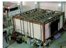
火災実験用実大区画 (散水設備対応)
